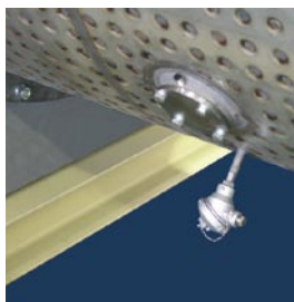
PT 100 Temperature Probe on Jacketed Mixing Chamber PT 100 Temperatursonde auf Doppelmantel Sonde thermométrique PT 100 sur double enveloppe Sonda termometrica PT 100 su scambio termico
