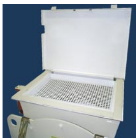
Inspection hatch with grille for manual material addition Inspektionsklappe mit Schutzgitter zur manuellen Produktzugabe Trappe de visite avec grille pour chargement manuel Portello d'ispezione con griglia per carico manuale
