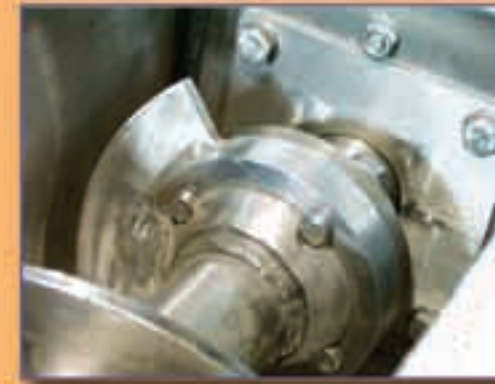
Flanged shaft coupling Geflanschte Wellenverbindung Accouplement d'arbre à bride Accoppiamento d'albero flangiato
