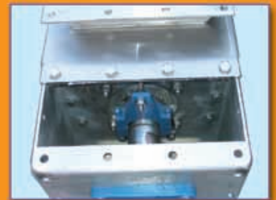
High quality seal and split gland Qualitätsabdichtung und geteilte Stopfbuchsbrille Étanchéité d'haute qualité et presse-étoupe sectionnée Tenuta ad alta qualità con premibaderna sezionata
