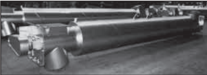
JACKETED COOLING SCREWS CONVEYORS FOR HIGH TEMPERATURE COAL SCHNECKEN MIT KÜHLMANTEL FÜR HEISSE KOHLE VIS TUBULAIRES AVEC CHEMISE DE REFROIDISSEMENT POUR TRANSPORT DE CHARBON A TEMPERATURE TRES ELEVEE COCLEA CON CAMICIA DI RAFFREDDAMENTO PER TRASPORTO CARBONE AD ALTISSIMA TEMPERATURA
