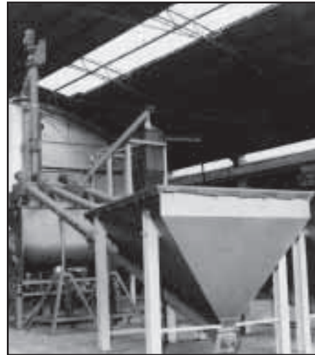
SCREW CONVEYOR FOR CHEMICALS DOSIERSCHNECKE IN CHEMIEFABRIK VIS TUBULAIRE POUR PRODUITS CHIMIQUES COCLEA PER PRODOTTI CHIMICI
