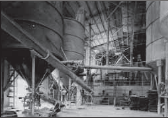
SCREW CONVEYOR FOR TRANSPORT OF RAW MATERIALS FOR CERAMIC GLAZINGS FÖRDERSCHNECKE FÜR ROHPRODUKTE ZUR HERSTELLUNG VON KERAMIK EMBRENNEMAILLE VIS TUBULAIRE TRANSPORT MATIERES PREMIERES POUR LAQUES CERAMIQUES COCLEA TRASPORTO MATERIE PRIME PER SMALTI CERAMICI
